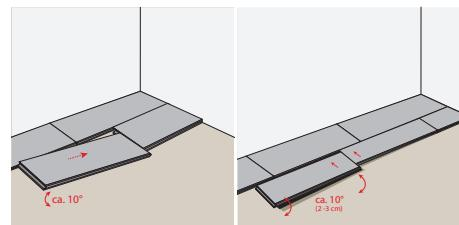
**PRIMA FILA:** Iniziare la posa partendo dall'angolo destro della stanza. Posare la prima doga in modo che il lato con l'incastro sia rivolto verso il muro. Allinearla perfettamente ai cunei distanziatori. Installare la seconda doga inserendo il lato corto con l'incastro maschio all'interno del lato corto femmina della prima doga.
