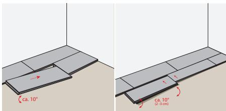
**ERSTE REIHE:** Beginnen Sie mit der Verlegung in einer rechten Raumecke. Legen Sie die erste Dielle so, dass die Federseite zur Wand zeigt. Richten Sie diese mit Abstandskeilen exakt aus. Die zweite Dielle heben Sie mit der stirnseitigen Feder in genauer Verlängerung an die erste stirnseitigen Dielennut ein.
