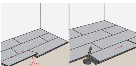
**PREMIÈRE RANGÉE:** Commencez à poser dans un coin droit de la pièce. Posez la première lame de telle sorte que le coté languette fasse face au mur. Alignez-la exactement avec les cales d'espacement. Placez la deuxième lame juste devant la première lame et emboitez les ensemble en tapotant à l'aide d'une cale de frappe et d'un marteau. Assurez-vous que les lames soient alignées.
