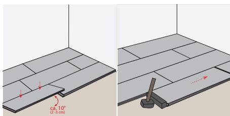
**PRIMA FILA:** Iniziare la posa partendo dall'angolo destro della stanza. Posare la prima doga in modo che il lato con l'incastro sia rivolto verso il muro. Allinearla perfettamente ai cunei distanziatori. Installare la seconda doga inserendo il lato corto con l'incastro maschio all'interno del lato corto femmina della prima doga. Assicurarsi che le doghe siano ben allineate.
