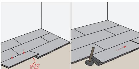
**ERSTE REIHE:** Beginnen Sie mit der Verlegung in einer rechten Raumecke. Legen Sie die erste Dielle so, dass die Federseite zur Wand zeigt. Richten Sie diese mit Abstandskeilen exakt aus. Die zweite Dielle legen Sie knapp vor die erste Dielle und klopfen diese mittels Schlagklotz und Hammer zusammen. Achten Sie dabei, dass die Dielen bündig sind.
